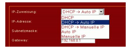
Der IP Mode bestimmt, wie der Netzer seine IP-Adresse, die Subnetzmaske und das Gateway allokiert.
