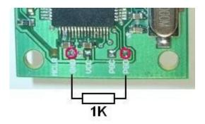
Während eines Neustarts muss das PGD-Pad über einen Widerstand (1K) auf Masse gezogen werden.
