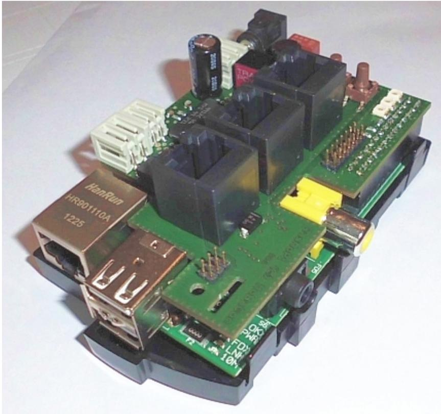
Es ist geplant, dass Rocrail auf dem Pi läuft und über eine P50X-Schnittstelle mit dem Erweiterungboard kommuniziert. Durch den Einsatz von Rocrail ist somit Zentrale und PC-Steuerung in einem Gerät verschmolzen.
